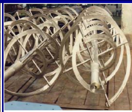
Espirales de ME-500 construidas en acero inoxidable, pulido espejo
