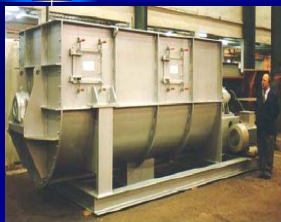
Mezcladora ME-800 de 8.000 l de capacidad construida en acero al carbono
